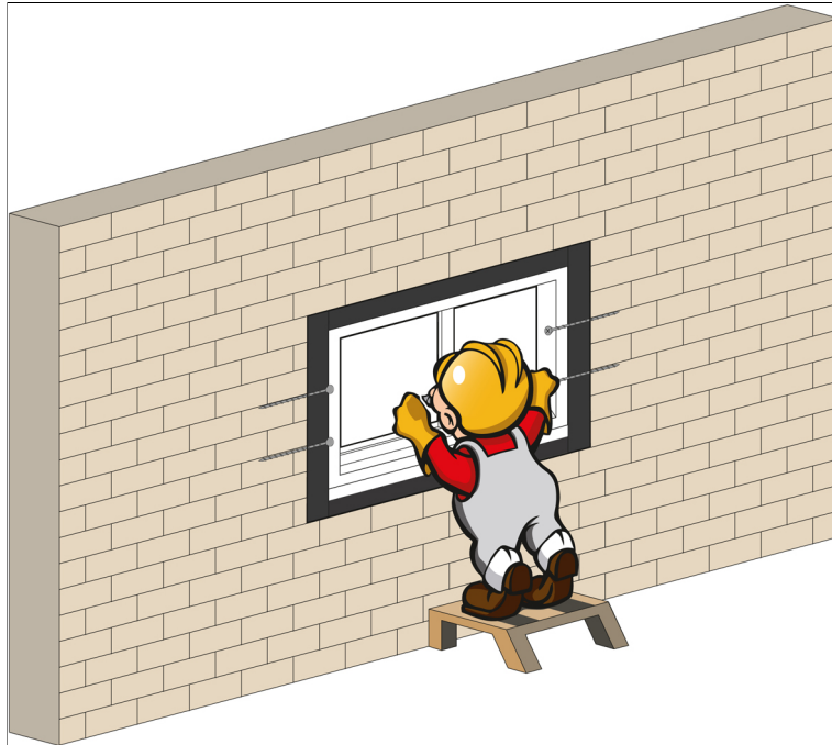
Βήμα 6: Τοποθετήστε, ευθυγραμμίστε και στερεώστε το πλαίσιο παραθύρου στο άνοιγμα.
